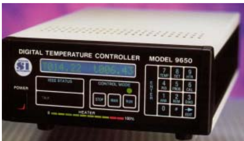
図 10.2.2 SI9650 の正面パネル 中央下部のキーパッド
