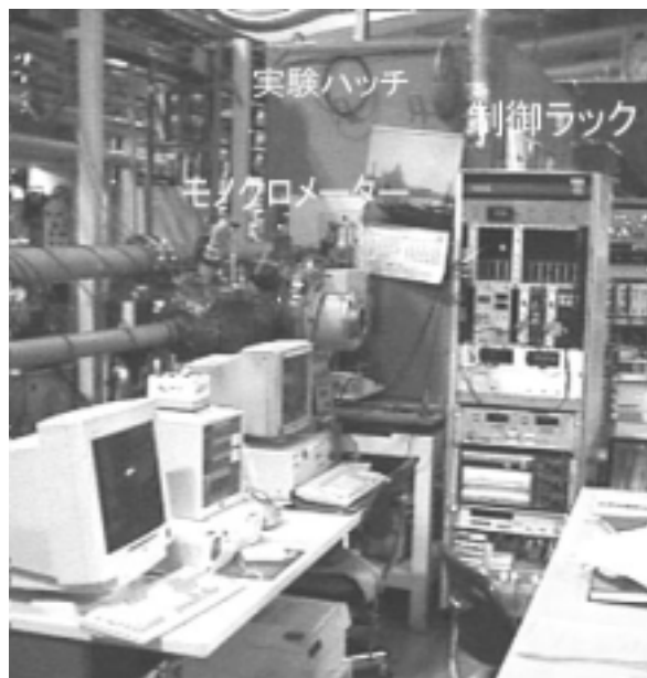
図 1.2.2 BL-10Bの様子。奥に実験ハッチ、その手前右に制御用ラック、左にモノクロメーターが見える。
