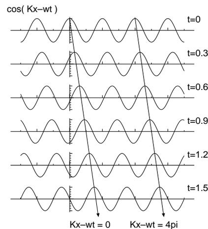
図2:  $\cos(Kx - \omega t)$  のグラフ。 $t = 0, 0.3, 0.6, 0.9, 1.2, 1.5$  と時間が経つにつれて同位相の点が進行していくように見える。
