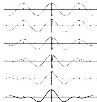
図 4: 波数の異なる波を重ね合わせて行く様子。一番上は  $\cos K_0 x$  だけ。下に行くに従って、 $\cos(1 \pm 0.1)K_0 x, \cos(1 \pm 0.2)K_0 x, \dots$  を足してある。下になると、 $x = 0$  から離れた所の振幅が小さくなっていく。
