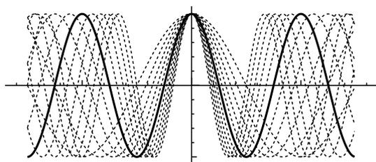
図 3:  $\cos(Kx - \omega t)$ , ( $t = 0$ ) で  $K$  が少しずつ異なる波。太い線で示したのが  $K = K_0$  の波、それ以外は、 $K = (1 \pm 0.1)K_0, (1 \pm 0.2)K_0, \dots$  の波。
