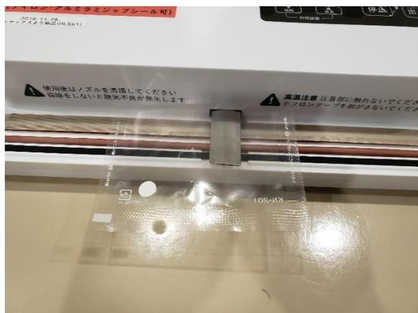
3. 試料の真空パックを行う。試料ホルダー等のサイズの都合でナイロンパックを切る可能性がある場合は、真空が破れるのを防ぐために、試料の周りを別のシーラー（例 富士インパルス 卓上シーラーP200 等）で井の字形に追加でシールしておく良い。
